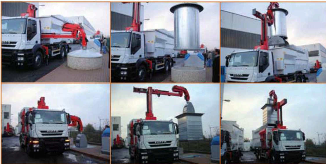
Фото 2. Заглубленные контейнеры большой емкости
