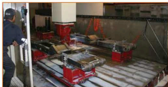
Цех финишной обработки отверстий (точность до нескольких микрон).
